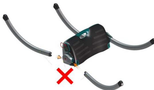
Incorrecte montage (bevestig NIET eerst de poten)
